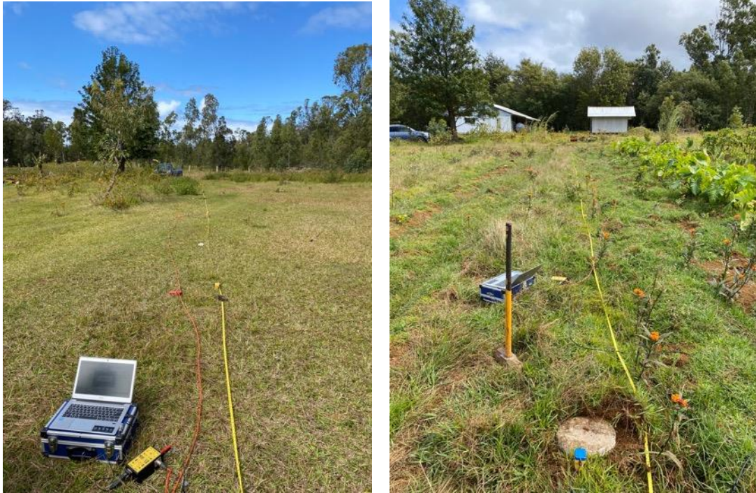
Figura 18. Arreglos lineales mediante geófonos verticales (izquierda arreglo 1, derecha arreglo 2).
